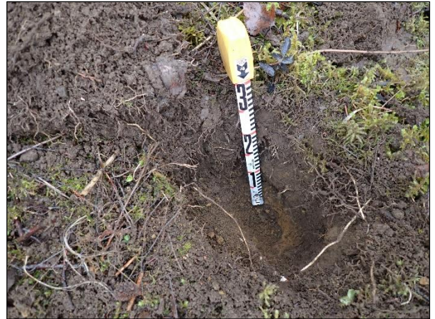
Rakenne 3:n viereen tehty koekuoppa. 0-20 cm multaista humusta, 20-30 cm vaaleanruskeaa hietaa.
