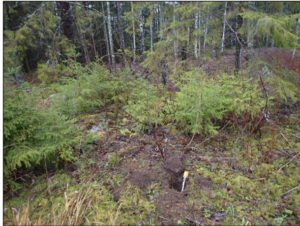
Rakenne 3:n viereen tehty koekuoppa. 0-20 cm multaista humusta, 20-30 cm vaaleanruskeaa hietaa.
