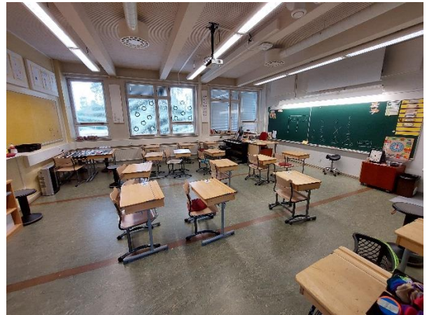
Kuva 34. Luokkatilojen lattiapäällysteenä on linoleum tai muovimatto
